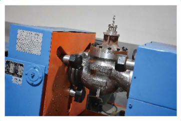
压力测试 pressure test
